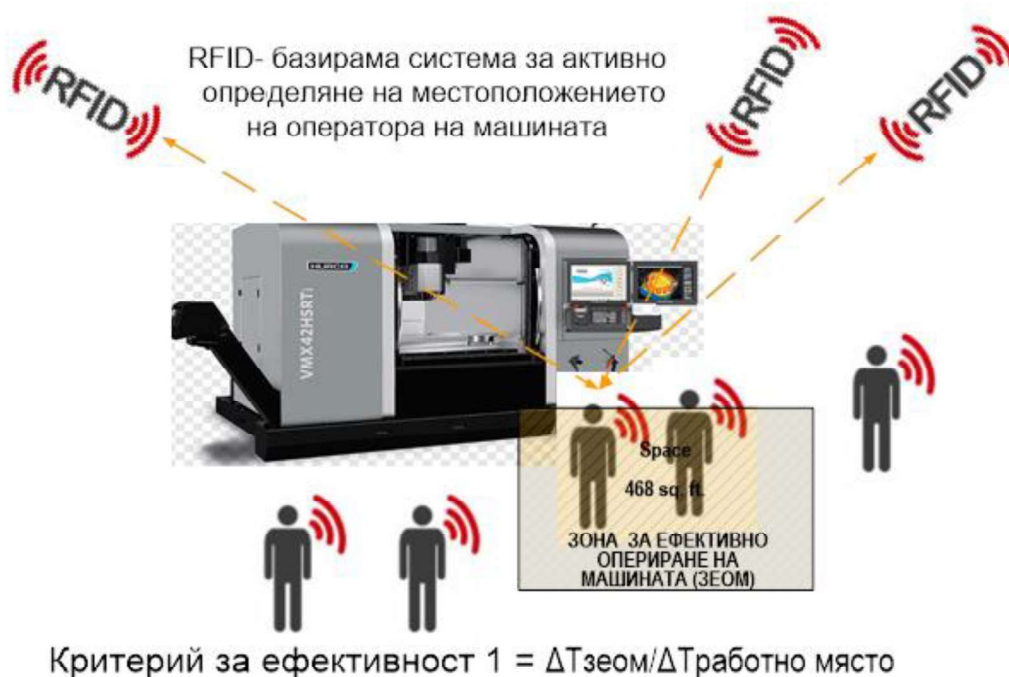
Фиг.1 Пример за ИТК базиран иновативен метод за обективна метрична оценка на ефективността на оператор на машина с цифрово програмно управление
