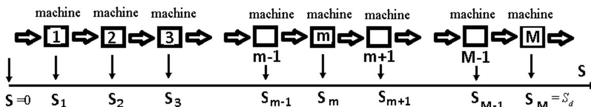
Рис.1. Схема линейной поточной линии
