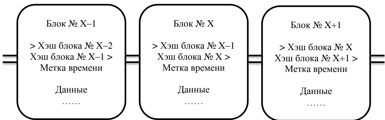
Рис.1. Схема возможного хранения данных в структуре блоков блокчейн
